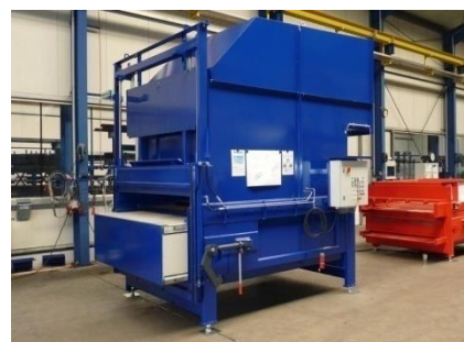
• ST - SEL - TS с гидравлической системой запирания двери
